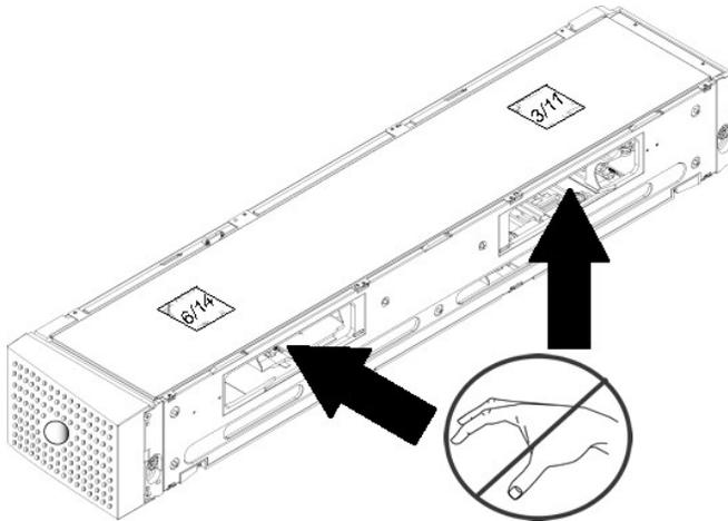
**注意：**建议您完全取下磁带架来装载和卸载磁带。如果磁带架没有完全取下，请不要旋转磁带架。
