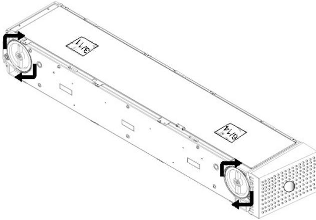
请勿把手伸进磁带架内推动磁带传输器来转动磁带架。您可以使用磁带架中的开口在每个磁带架的八个插槽中装载和卸载磁带。
