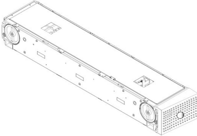
两个磁带架仓内都正确装入磁带架或者磁带架填充器之后磁带自动加载机才能运行。封闭开口的一种方法是使用两个磁带架。如果您只使用一个磁带架，则您必须用一个磁带架填充器填充另一个磁带架开口，以使单元可工作。
